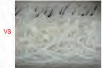
图(b) 常规浸灰法灰皮横截面放大图
